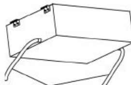
Mangueira de drenagem
